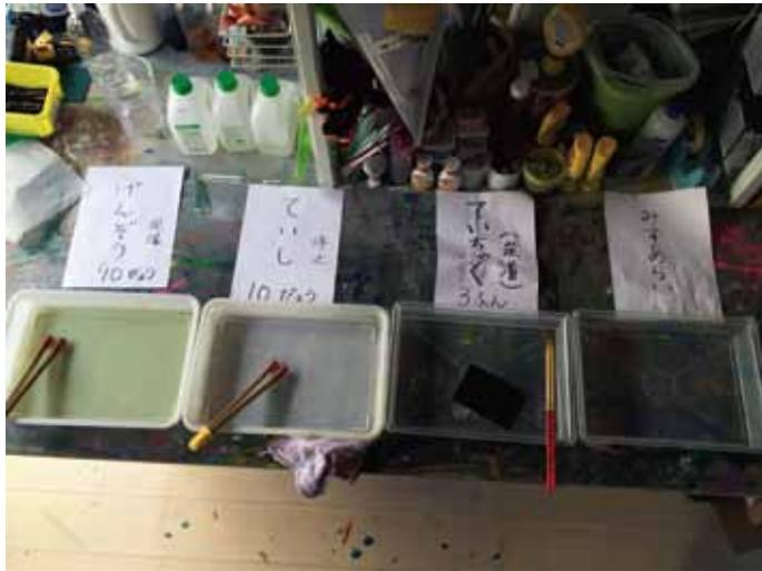
各薬液をバットにうつし、現像>停止>定着>水の順にならべる。
